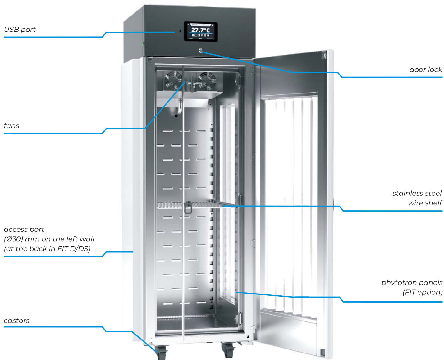
Climatic chamber KK 500 Smart PRO FIT DS
