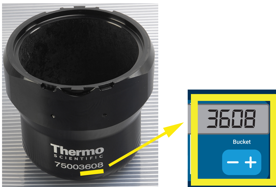
Figur 3–8: Indstilling af den rigtige bægerkode for rotoren
