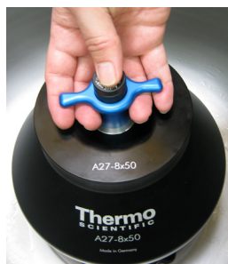
Illustration 25: Sådan holdes rotoren fast, når den tages ud
