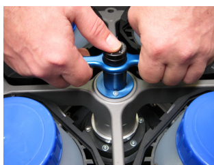
Illustration 25: Sådan holdes rotoren fast, når den tages ud
