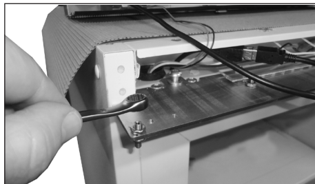
14. Tighten pivot nut
